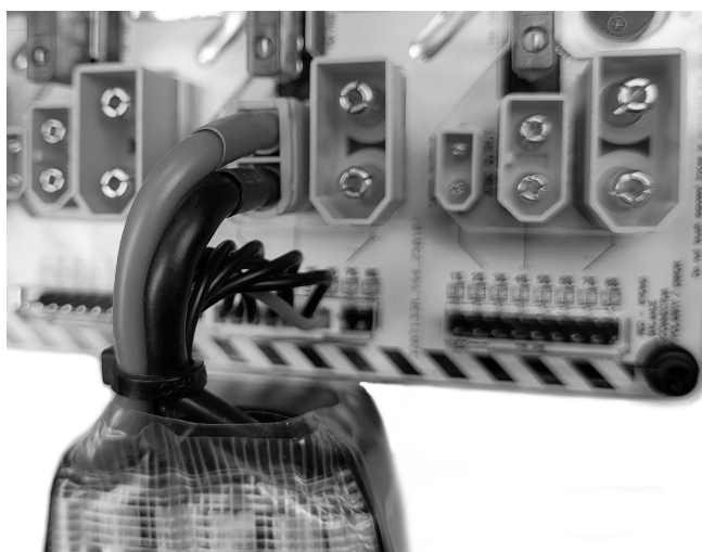
6. Підключення силового роз'єму акумулятора (XT 60)
